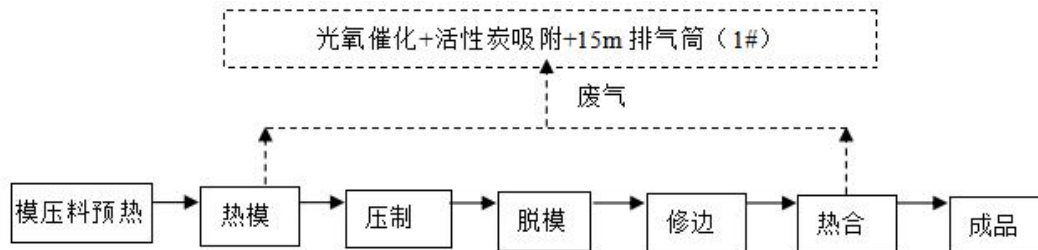
图 2-7 吸塑热合工艺流程图
