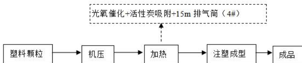
图 2-4 注塑工艺流程图
